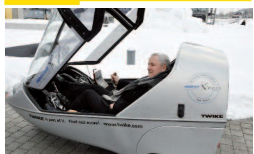
TWIKE – ekologiczny pojazd napędzany przez człowieka oraz elektryczność.
